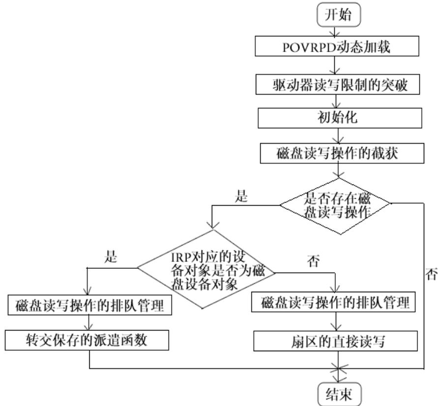
图2 POVRPD 虚拟还原技术的处理流程
